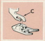
2. Leg de nieuwe persvoet midden onder de stang C en zet de persvoetheboom zó omlaag dat de stang over de persvoetpen past.
